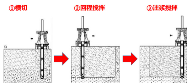
> 图2 TRD工法防渗墙施工工艺流程
